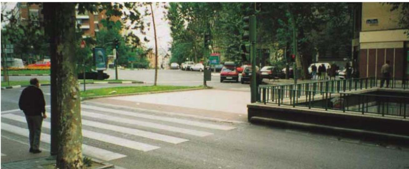
*Foto 2: Isleta situada sobre paso subterráneo de vehículos, con pavimento diferenciado en los vados de acceso a la misma*
